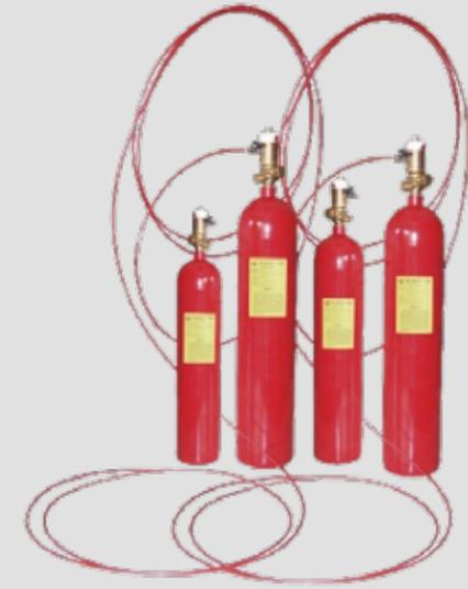
探火管式灭火装置,是近几年国内外发展起来的一类灭火装置,是一套简单、低成本且高度可靠的独立自动探测灭火系统。该类灭火装置采用柔性可弯曲的探火管作为火灾的探测报警部件,同时这种探火管还可以兼作灭火剂的输送及喷放管道。柔性的探火管可以很方便地布置到每一个潜在的着火源的最近处,一旦发生火灾,探火管受热破裂,立即释放灭火剂灭火。
